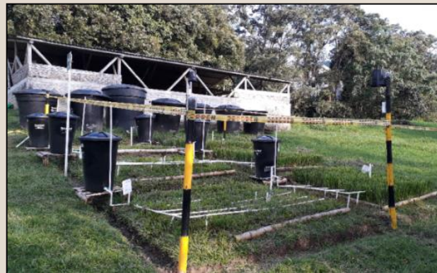
Panorámica de los tanque de alimentación al terreno. Uno por parcela.
