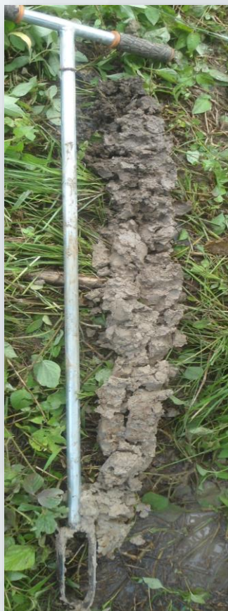
Barrenada en suelo con mal drenaje
